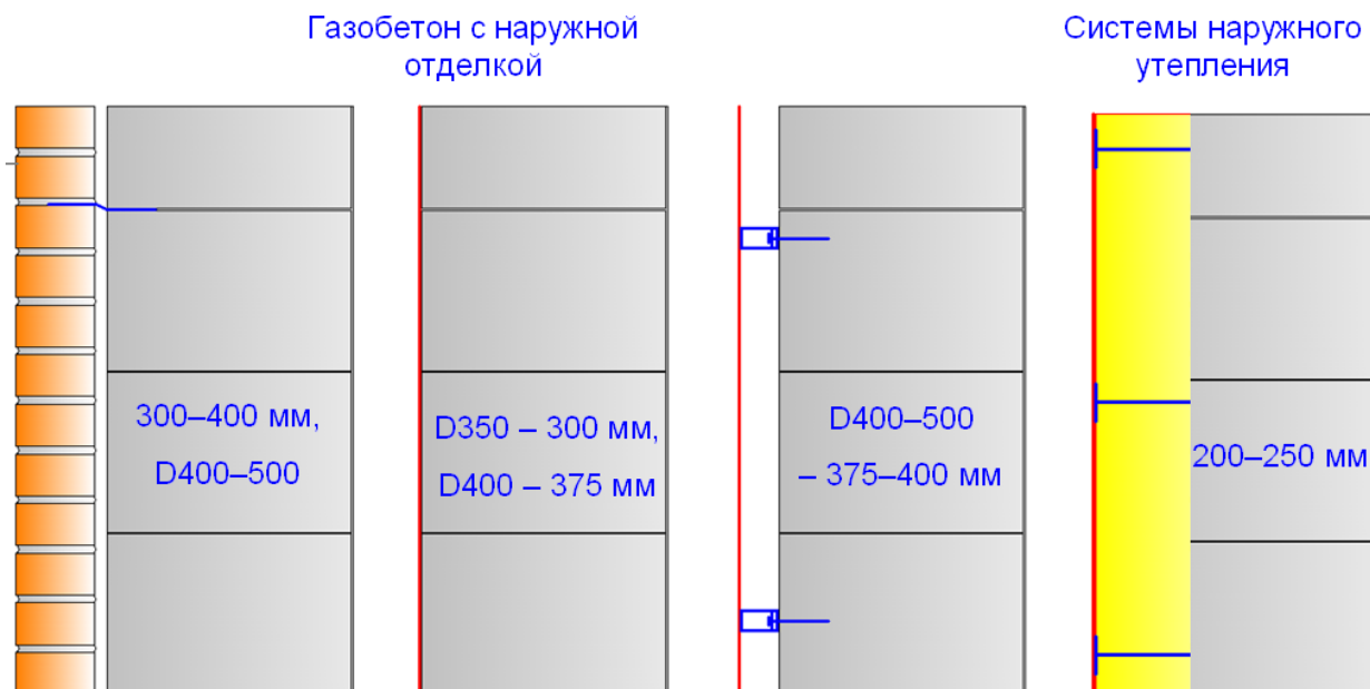
Рис. 1. Основные варианты стеновых заполнений с применением кладки из автоклавных газобетонных блоков в монолитном строительстве Санкт-Петербурга
